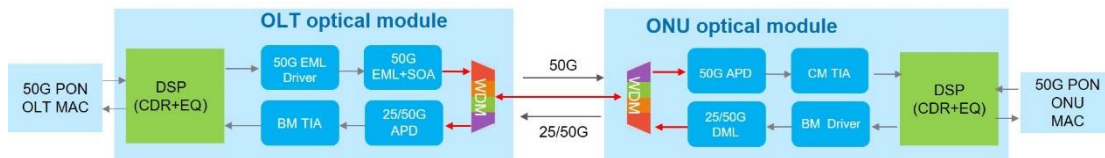
图 2 50G PON 光模块内部结构示意图
